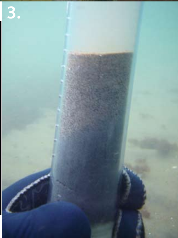
SEDIMENTPROPPAR I DET PÅVERKADE OMRÅDET. Kartan visar var propparna är tagna. Bild 1: Sedimentpropp vid punkt 1, med grovsand överst och underliggande finsand. Bild 2: Sedimentpropp vid punkt 2, med grovsand och ett tunnt mellan-skikt med finsand. Bild 3: Sedimentpropp vid punkt 3, med grovsand överst och underliggande finsand.
